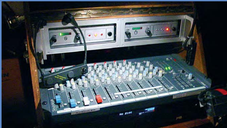
Dispositif d'audiodescription : régie, table de mixage, radiateur infrarouge et casque récepteur sans fil. Cl. Association Accès Culture
