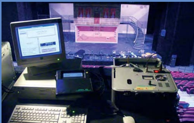
Dispositif de surtitrage individuel proposé lors de représentations au théâtre national de Chaillot (Paris) : micro-ordinateur de traitement de texte en régie, émetteur hautes fréquences et livret électronique recevant l'information.
