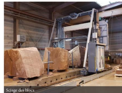
Sciage des blocs
